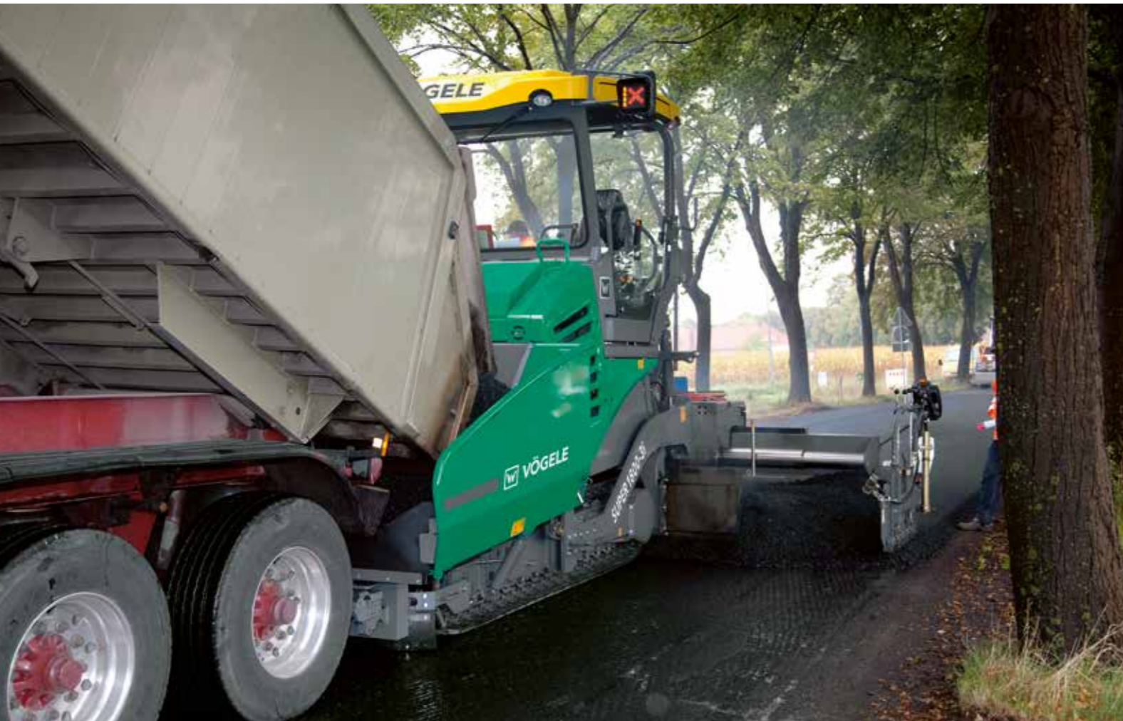
Yaylı itme makarası PaveDock, malzeme taşıtlarının tüm darbelerini güvenilir biçimde dengeler.
