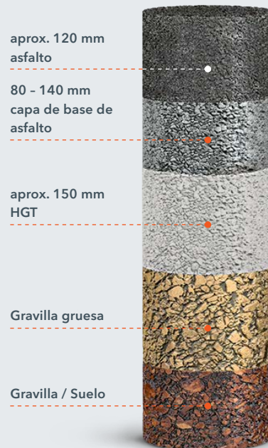
Estructura de carretera con HGT (ejemplo)
