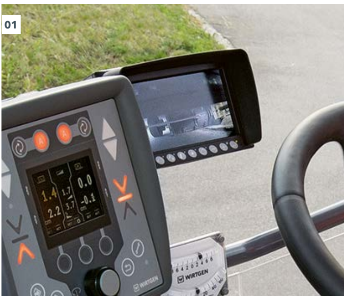
01 La surveillance vidéo des principales zones de travail est un réel atout en termes de rendement et de qualité. 02 L'opérateur dispose d'une vue dégagée sur le panneau latéral droit.
