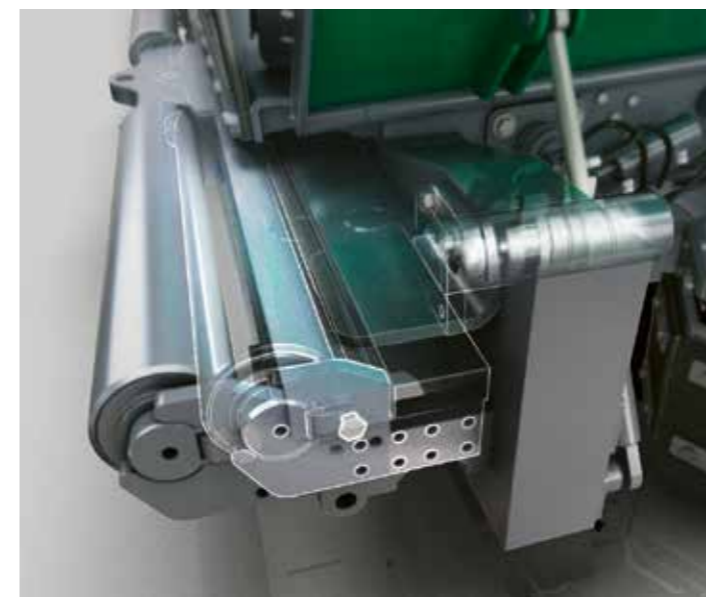
Rodillo de empuje "PaveDock" con suspensión elástica, que compensa confiablemente todos los choques de los camiones de mezcla.
