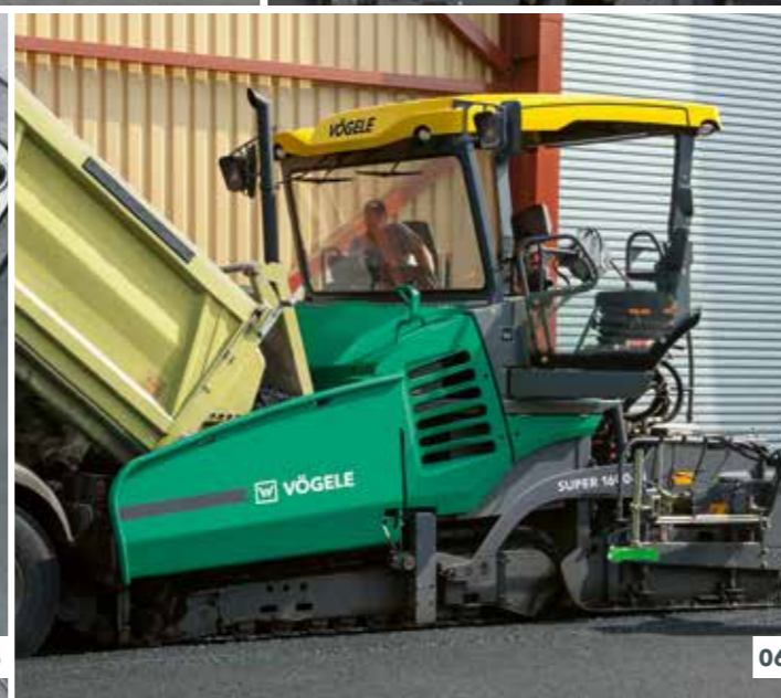
04 El concepto de plataforma ofrece una excelente visibilidad. 05 Desarrollos automáticos con "AutoSet Plus". 06 Alimentación óptima gracias el rodillo de empuje con suspensión elástica "PaveDock" y el sistema de comunicación "PaveDock Assistant".
