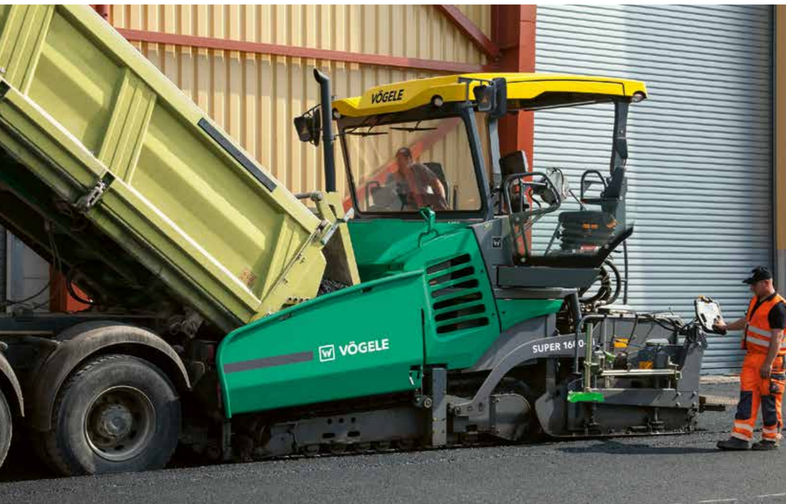
Rodillo de empuje "PaveDock" con suspensión elástica, que compensa confiablemente todos los choques de los camiones de mezcla.
