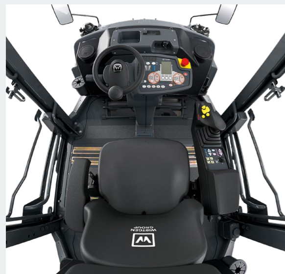
Der Easy Drive-Fahrerstand ist komfortabel, geräumig und ergonomisch optimiert.
