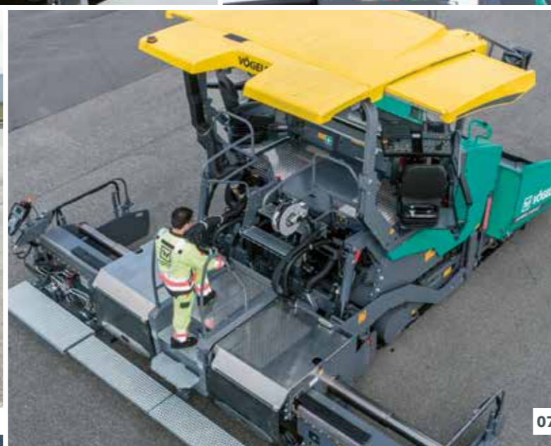
05 PaveDock Assistant semplifica la comunicazione durante la movimentazione del conglomerato. 06 Postazione di lavoro più ordinata ed ergonomica. 07 Pedana di salita sul banco più sicura e comoda.
