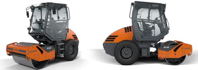
Os cilindros compactadores extremamente compactos e muito curtos da HC CompactLine oferecem uma enorme capacidade de inclinação de até 60% e máxima distância do solo. O acionamento é realizado por modernos motores de roda. A curtíssima distância entre eixos e a articulação giratória pendular de 3 pontos garantem ótimas características de condução e manuseio, ideais para canteiros de obras estreitos e compactação em terrenos acidentados.
