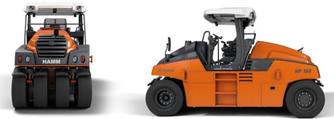
Os cilindros compactadores de pneus da série HP são convincentes na construção de asfalto e na terraplanagem. Todos os modelos oferecem uma plataforma do operador espaçosa e confortável. Uma estrutura assimétrica e um design inteligente da máquina criam excelentes condições de visibilidade. Além disso, a operação é neutra em termos de idioma. Ela facilita o trabalho dos operadores e contribui para a segurança.
