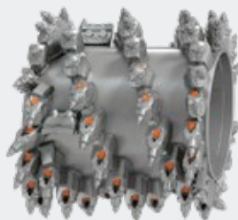
Tambour de fraisage standard Largeur de fraisage : 900 mm Profondeur de fraisage : 0 - 280 mm Écartement des pics : 15 mm
