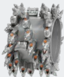
Tambour de fraisage standard Largeur de fraisage : 600 mm Profondeur de fraisage : 0 - 280 mm Écartement des pics : 12 mm
