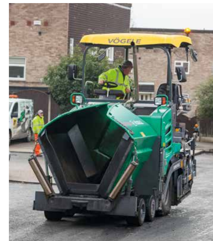
Beim Hochklappen der Behälterwände werden die LKW-Abdruckrollen automatisch mit nach oben geklappt.
