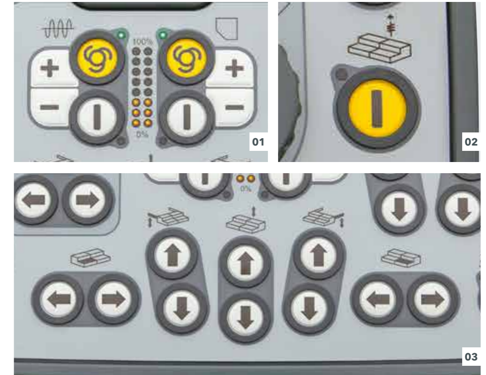
01 Verdichtungsleistung 02 Bohlenentlastung (Option) 03 Bohleneinstellungen
