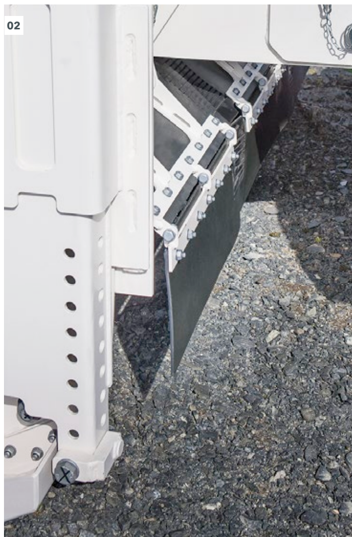
01 Il paraspruzzi evita il lancio di sassi e riduce il sollevamento di polveri durante il lavoro.
