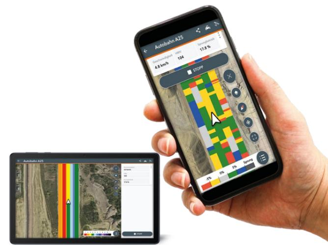
El intercambio de datos entre el control de máquinas, la aplicación Smart Doc y el receptor inteligente se realiza por Bluetooth.
