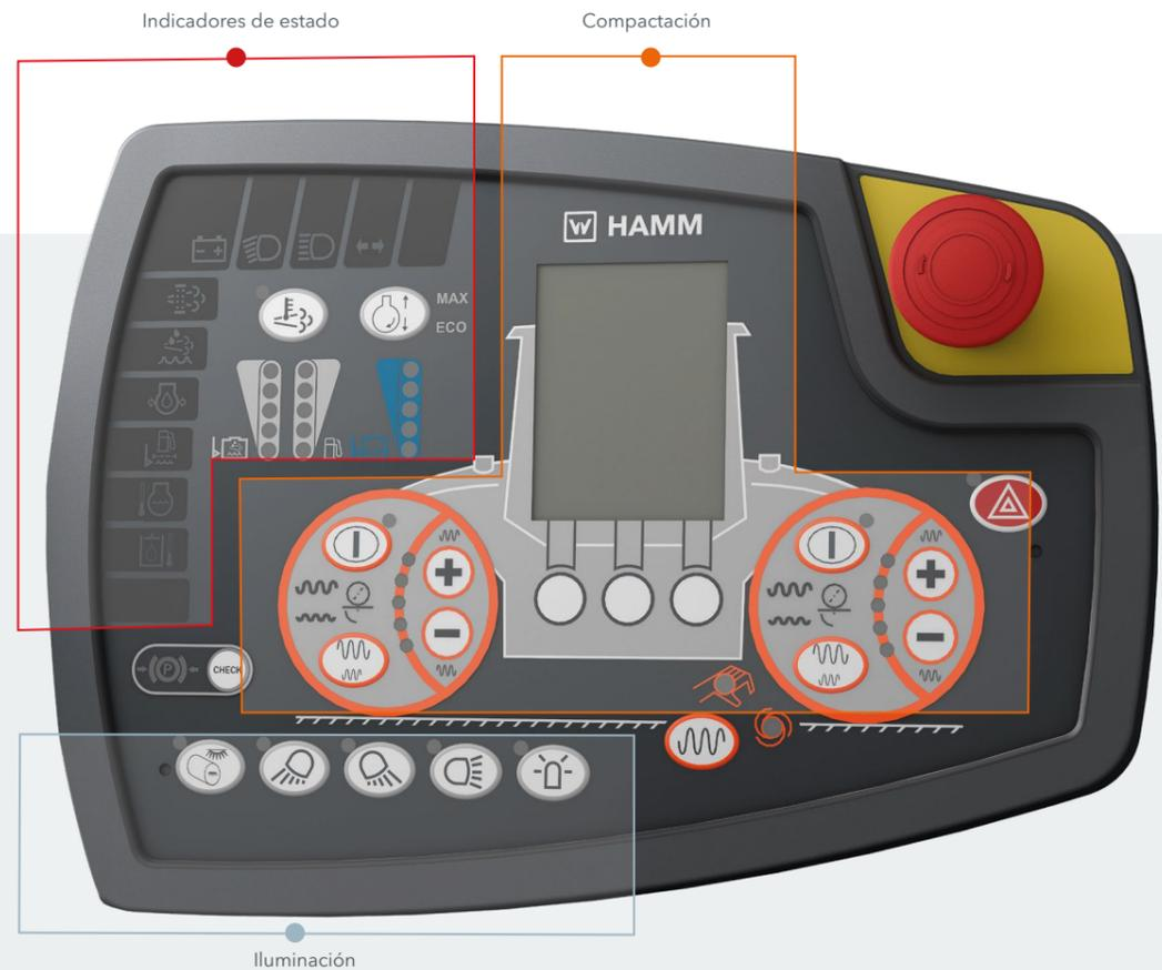
En el tablero de instrumentos junto al volante se encuentran los indicadores de estado y de parámetros, así como los pulsadores de uso menos frecuente.
