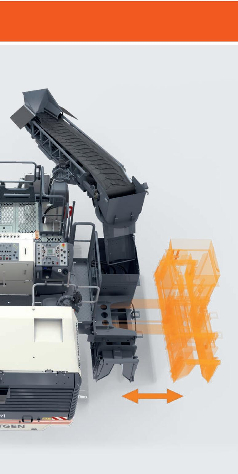
**01** Die Zuführung - optional als Förderband oder Zuführschnecke - kann hydraulisch nach rechts oder links gedreht werden. Die Gleitschalung ist wahlweise rechts oder links einfach montierbar und seitlich hydraulisch teleskopierbar.
