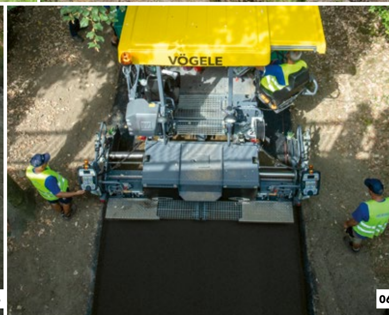
04 Конструкция платформы обеспечивает отличный обзор. 05 Оптимальная загрузка благодаря вместительному приёмному бункеру. 06 Благодаря раздвижному рабочему органу AB 340 TV достигается высокая степень предварительного уплотнения.
