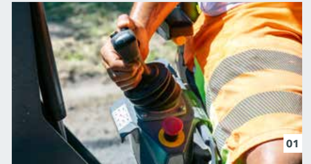
Для управления поворотным конвейером служит джойстик, встроенный в подлокотник сиденья.
