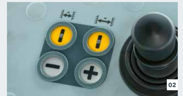
Система автоматического контроля расстояния между машинами позволяет выбирать одно из двух расстояний.
