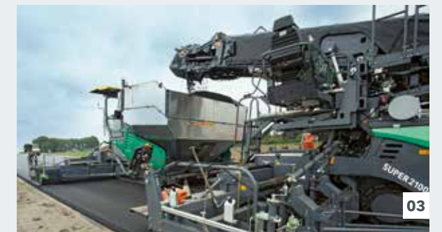
Через перегрузочный модуль укладчика для устройства слоя биндера смесь попадает в укладчик.
