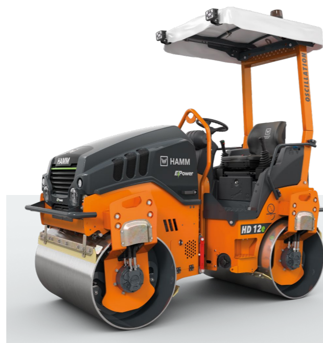
Techo de protección
