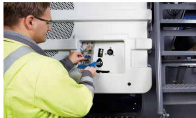
> Вставить элемент управления в деблокиратор; ротор надёжно застопорен и ключ доступен для выполнения последующих операций.
