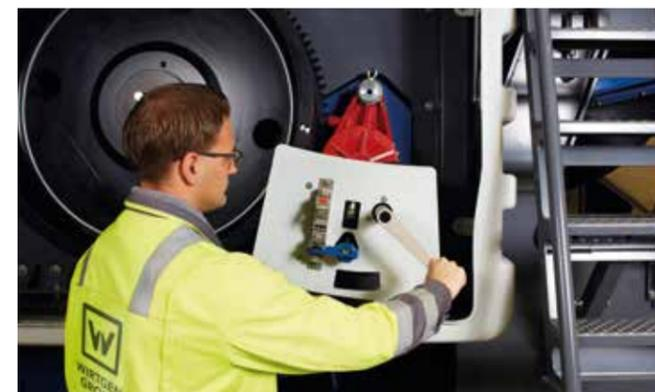
> С помощью кривошипной рукоятки ротор можно безопасно проворачивать и устанавливать его в оптимальное для замены бил положение.
