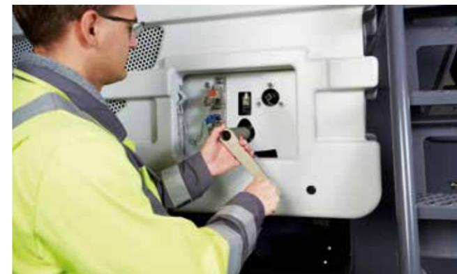
> Устройство для блокировки и проворачивания ротора разблокировано и может приводиться в действие кривошипной рукояткой.
