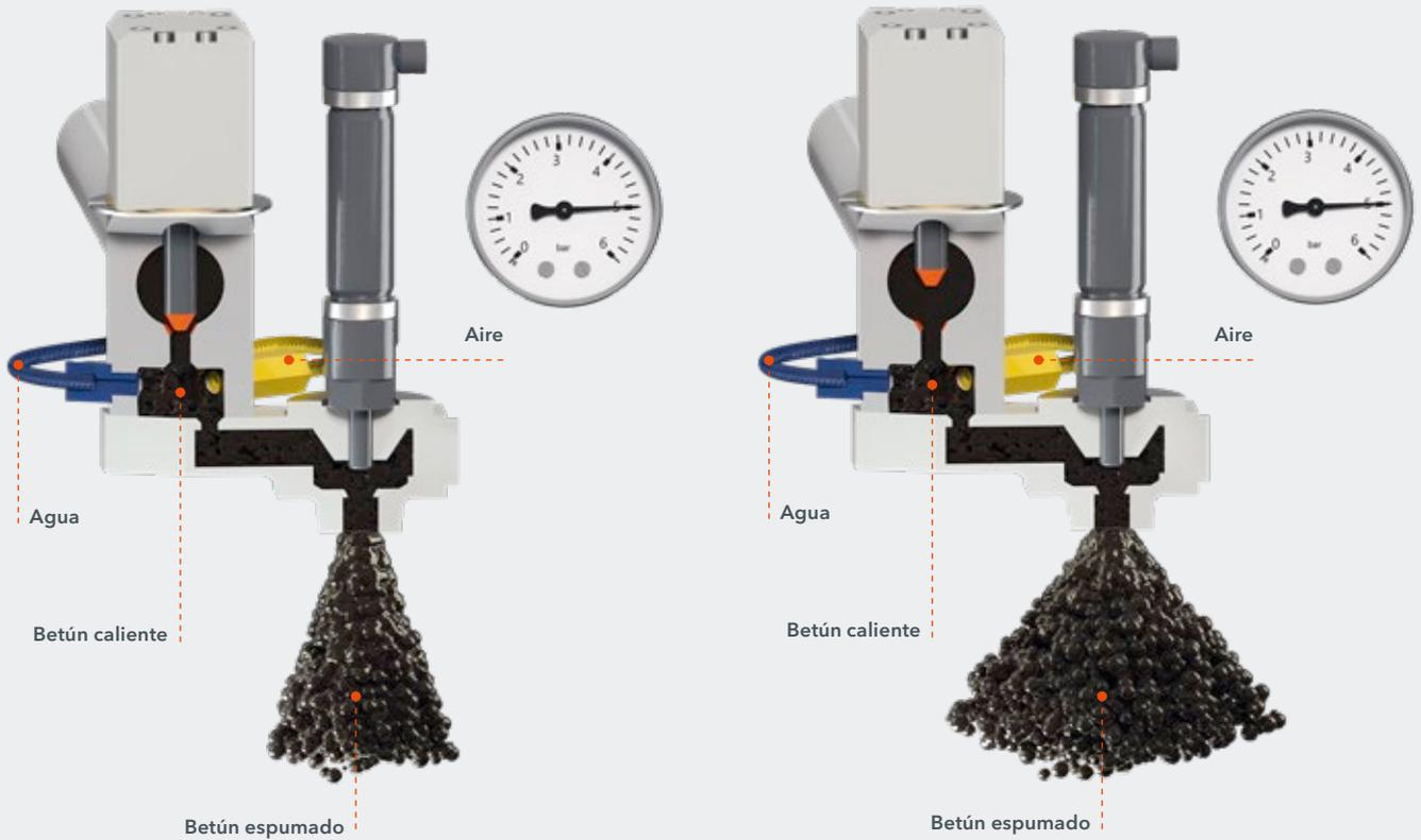
El betún espumado se produce mediante la inyección controlada de aire comprimido y agua en el betún caliente.
