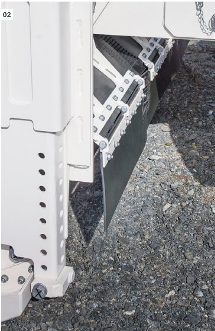
01 Der Spritzschutz bewährt sich im Einsatz: Kein Steinschlag sowie weniger Staub.
