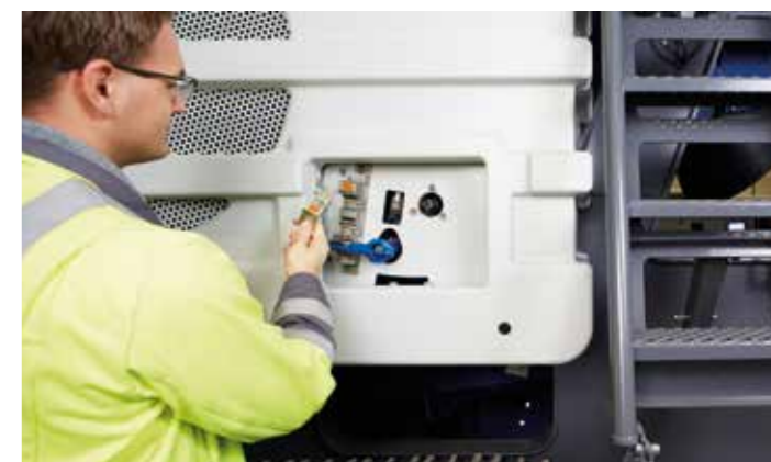
> Quando le chiavi vengono rimosse, il rotore rimane assicurato in modo affidabile.
