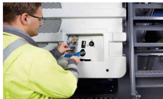
> Innestare l'elemento di comando nella stazione di abilitazione; il rotore è bloccato in modo sicuro e la chiave è abilitata per altri passaggi.
