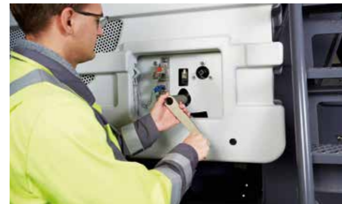
> Il dispositivo di blocco rotore e rotazione è abilitato e può essere mosso con una manovella.
