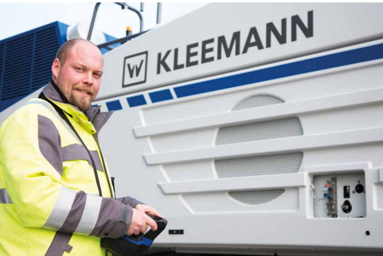
> Innestare l'elemento di comando nella stazione di abilitazione; il rotore è bloccato in modo sicuro e la chiave è abilitata per altri passaggi.
