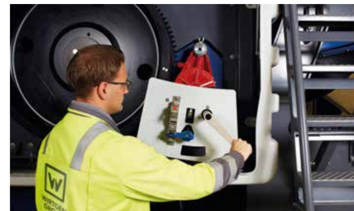
> Il rotore viene fatto girare senza rischi con la manovella e portato nella posizione ottimale per il cambio dei martelli.
