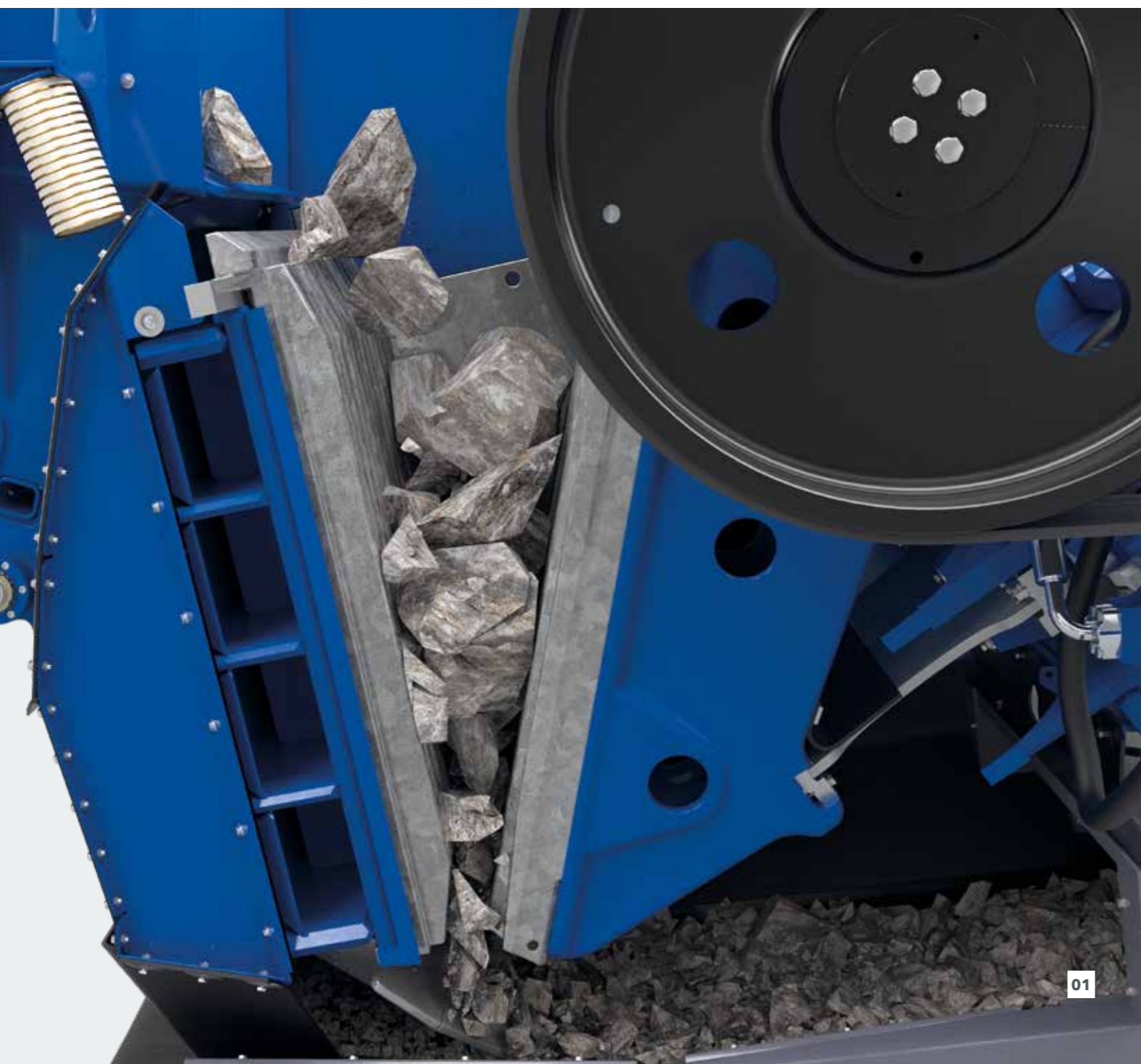
01 Geometria del frantoio 02 Piastra deflettrice 03 Sistema di sbloccaggio frantoio
