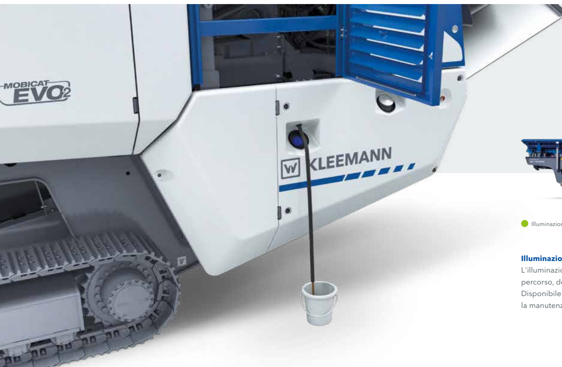
Punto di scarico centralizzato
