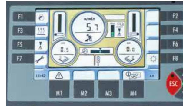
Anzeige maximale Einbaugeschwindigkeit Die Anzeige zeigt die maximal mögliche Einbaugeschwindigkeit, mit der man die gewählte Sprühmenge noch flächendeckend auftragen kann.
