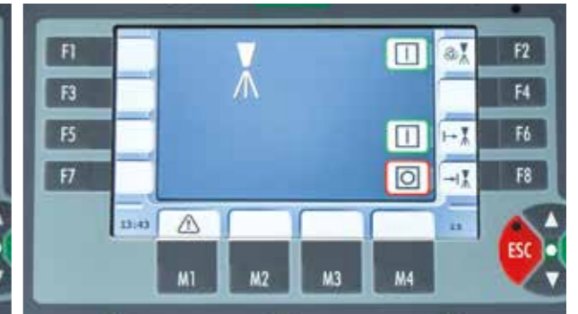
Funktionen Baustellenanfang/-ende Damit genau an der gewünschten Stelle und über die gesamte Arbeitsbreite der Sprühvorgang beginnt bzw. endet, gibt es die Komfortfunktionen für Baustellenanfang (F6) und Baustellenende (F8).
