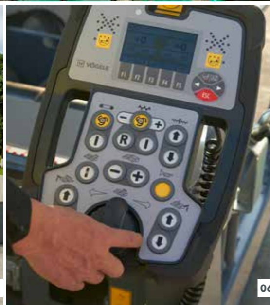
04 Optimale Beschickung dank Kommunikationssystem PaveDock Assistant 05 Großer Materialbehälter mit 13 Tonnen Fassungsvermögen 06 ErgoPlus 3 Bohlen-Bedienkonsole mit SmartWheel für komfortable Bohlenbreitenverstellung
