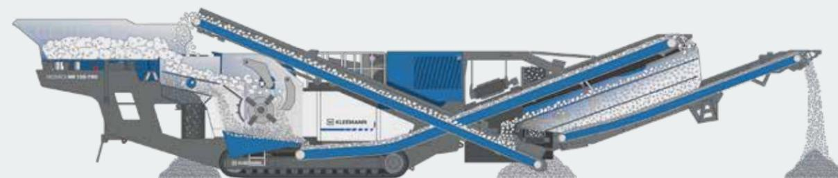
La MOBIREX MR 130(i) PRO convince per l'ottima qualità del prodotto e per l'elevatissima resa produttiva. Il Continuous Feed System CFS assicura un'alimentazione continua del frantoio. Grazie alla regolazione fessura completamente idraulica, è possibile adattare velocemente i parametri macchina alla relativa applicazione. Il sistema di sovraccarico garantisce un'efficace protezione del frantoio e un'elevata efficienza
