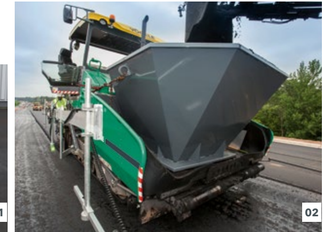
01 Alas de tolva operadas de manera independiente. 02 Está disponible una tolva receptora adicional para la extendidora para suministrar mezcla desde una alimentadora.
