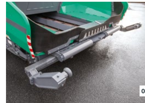
01 Motor diésel con fases del número de revoluciones 02 Dirección con ángulo de dirección preseleccionado 03 Enganche para camión disponible opcionalmente
