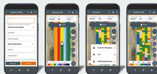
O intercâmbio de dados entre o controle da máquina, o Smart Doc e o receptor GNSS é realizado por Bluetooth.
