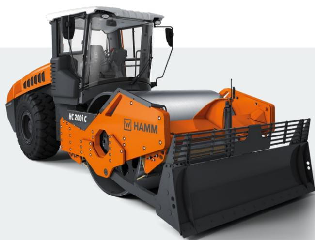
A lâmina de nivelamento está disponível para máquinas de até 20 t com rolo liso e de pé de compactação.
