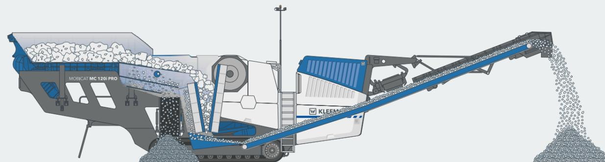
Le MOBICAT MC 120(i) PRO dispose d'une unité d'alimentation largement dimensionnée permettant de charger sans problème de grandes quantités de matériau avec une excavatrice ou un chargeur sur roues. La haute performance de l'installation se reflète également dans les dimensions du gueulard et dans la version extra-longue de la mâchoire mobile. Ceci permet le chargement de grosses roches.
