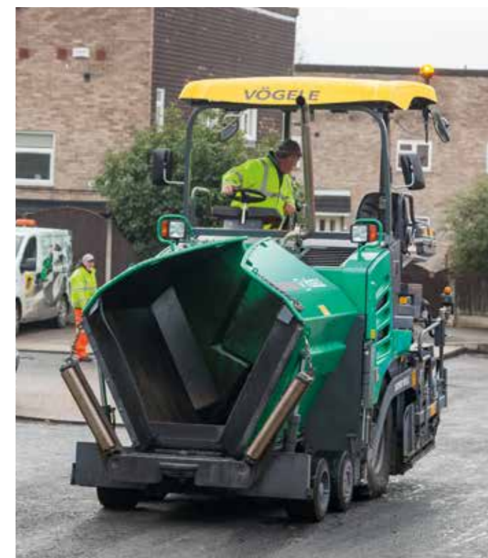
Plegando hacia arriba las paredes de la tolva también se pliegan los rodillos de empuje del camión.
